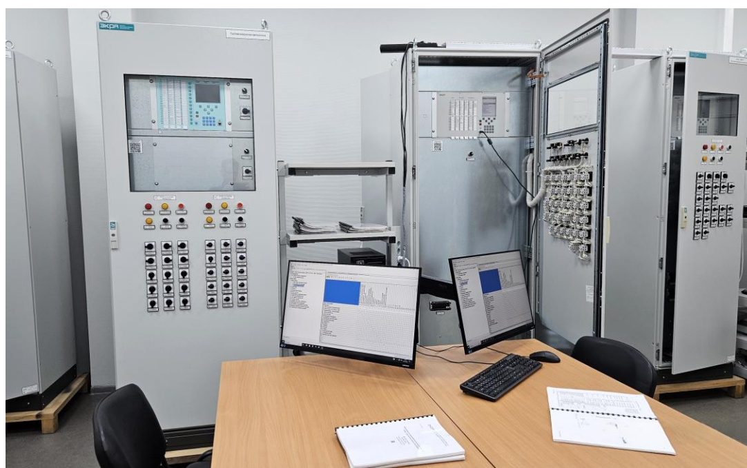
Рис. 11 Лабораторный комплекс на основе шкафа ШЭЭ 223 0301
