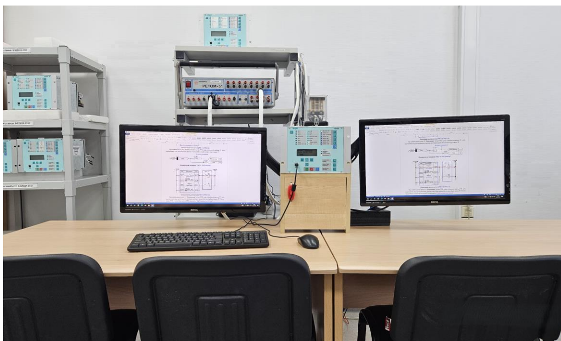
Рис. 7 Лабораторный комплекс на основе терминала БЭ2502
