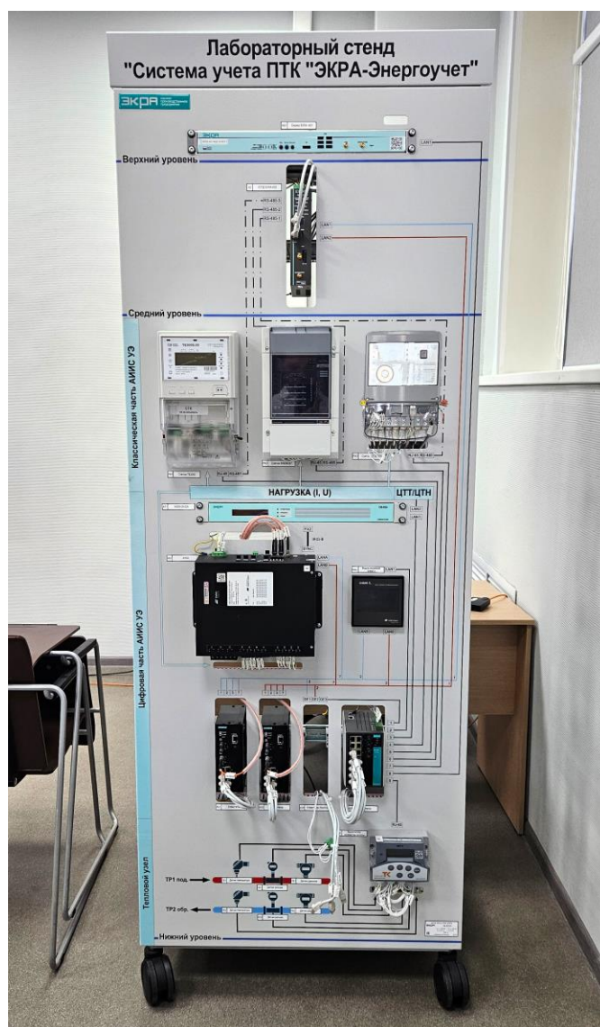
Рис. 17 Лабораторный комплекс «Система учета ПТК «ЭКРА-Энергоучет»
